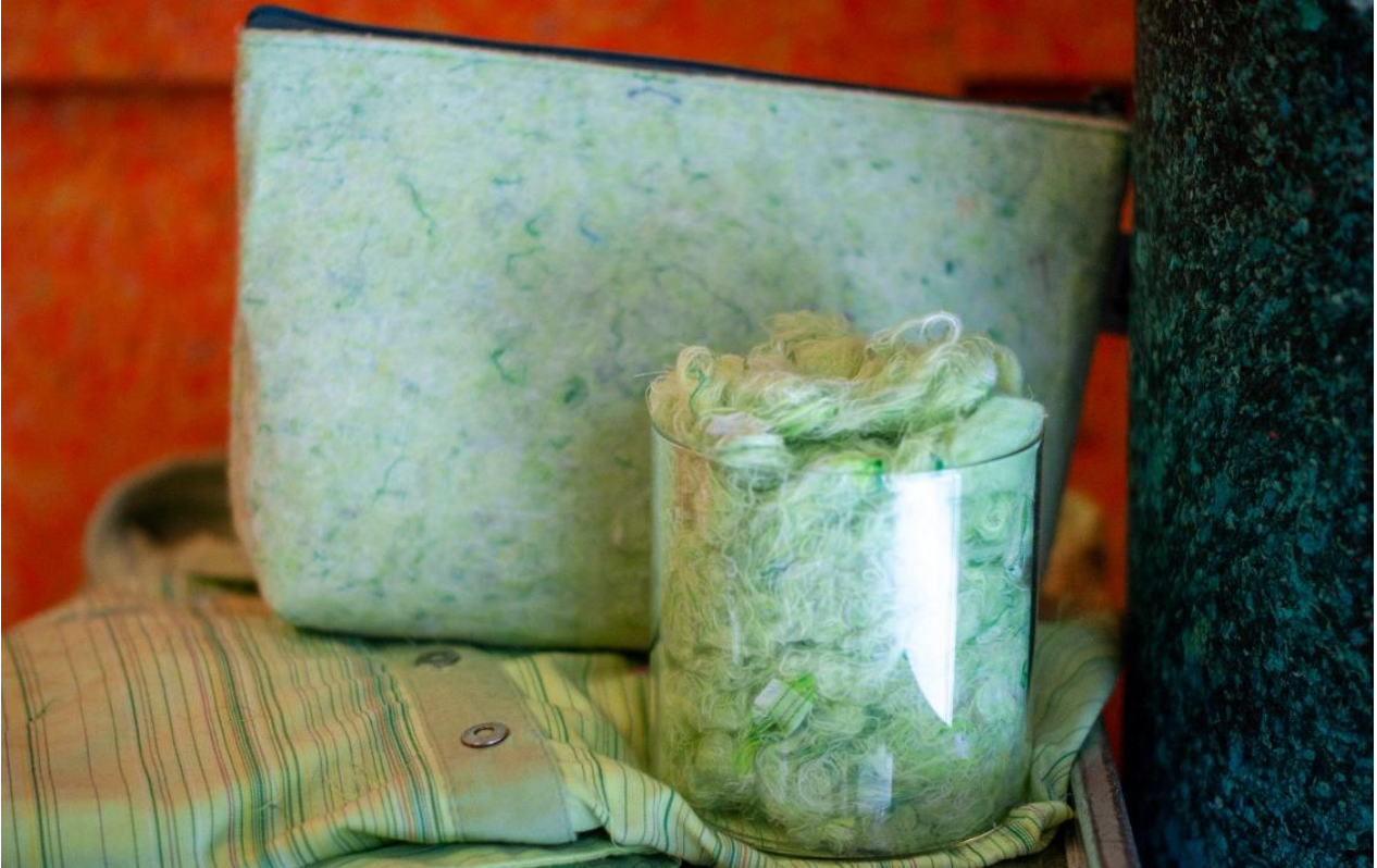
Prisman vanha työvaate, siitä saatu raaka-ainekuitu ja kuidusta valmistunut jämäkkä säilytuspussi. KUVA: Johanna Laapio
